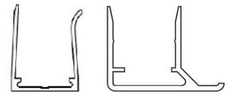
Ukončovací U profily jsou dodávány polykarbonátové (čiré – průhledné) a hliníkové (přírodní hliník, elox stříbrný nebo hnědý – stejně jako hliníkové přitlačné lišty). PC U profily na deskách nedrží pevně a např. v období tání sněhu by mohly ze spodní strany desek padat. Z tohoto důvodu doporučujeme jejich použití max. z horní strany desek/přístřešku.
