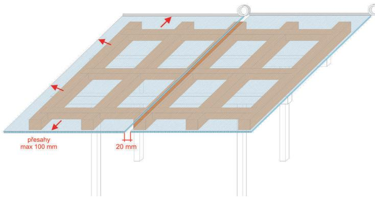
Při instalaci je třeba počítat s tepelnou roztažností desek (až 3 mm/m ve všech směrech), a proto je používán systém beztlakého zasklívání, tzn. upevňování desek k nosné konstrukci pomocí hliníkových přitlačných lišt s pryžovým těsněním. Mezi jednotlivými deskami vynechávejte 20 mm dilatační mezeru, kterou překryjte přitlačnou hliníkovou krycí lištou.
