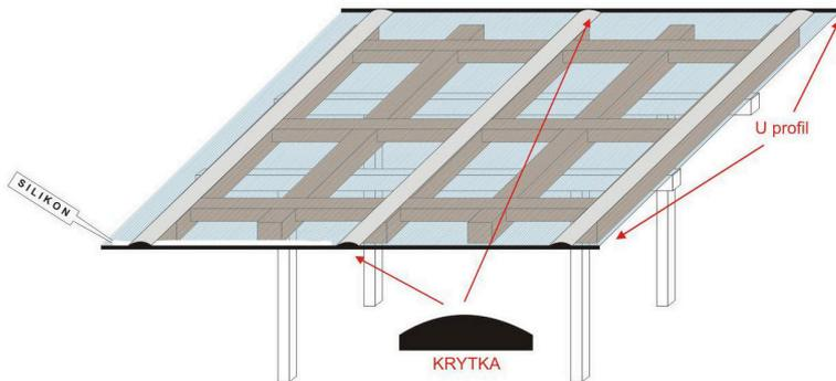
**Na závěr montáže** nasadte ukončovací U profily, v místech s předpokladem netěsnosti dotěsněte. K dotmelování se zásadně používají silikonové tmely kompatibilní s polykarbonátem (bývá uvedeno na kartuších s tmelem, např. silikon neutral). Zabraňte vnikání částeček a výparů do komůrek. Ukončovací U profily je nutné používat na stranách desek s otevřenými komůrkami (nahore a dole).
