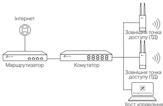
Комп'ютер який використовується для централізованого управління ТД з встановленим відповідним ПЗ, може знаходитись в одній чи різних підмережах з ТД.
