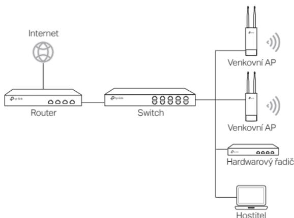
Hardwarový řadič může být ve stejné nebo jiné síti jako AP. Hostitel je použit pro přihlášení k hardwarovému řadiči a centrálnímu řízení AP.
