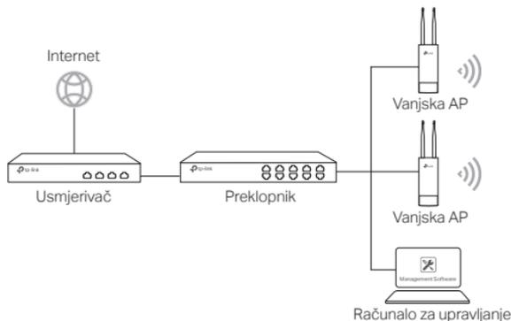
Računalo na kojem je pokrenut softver za središnje upravljanje, koje može biti u istoj ili različitoj podmreži u odnosu na pristupne točke, služi za središnje upravljanje pristupnim točkama.
