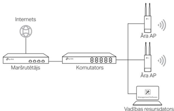
Dators, kurā darbojās centralizēta pārvaldības programmatūra, kas var būt vienā un tajā pašā ar AP vai atšķirīgā apakštīklā, tiek izmantots centralizēti pārvaldīts AP.
