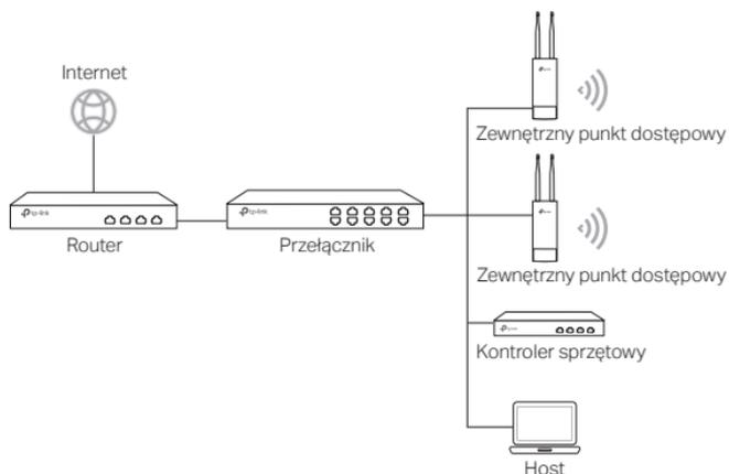
Kontroler sprzętowy może być w tej samej lub w innej podsieci co punkty dostępowe. Host stosowany jest do logowania się do kontrolera sprzętowego i zarządzania w ten sposób punktami dostępowymi.
