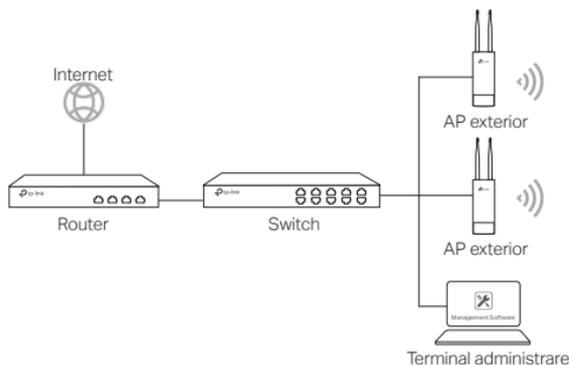
Un computer care rulează aplicația pentru management centralizat, din aceeași subrețea cu dispozitivele AP sau din altă subrețea, este utilizat pentru administrarea centralizată a acestora.
