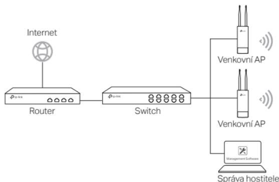
Počítač provozující software centralizovaného řízení, který může být ve stejné nebo jiné síti jako AP, je použit pro centrální řízení AP.
