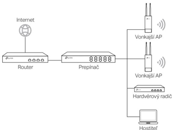
Hardvérový radič môže byť v rovnakej alebo odlišnej podsieti s AP. Hostiteľ správy sa používa na prihlásenie sa do hardvérového radiče na centrálnu správu AP.
