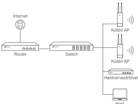
A hardvervezérlővel azonos vagy eltérő alhálózaton lehet az AP-kkal. A vezérlő egységgel beléphet a hardvervezérlővel, és központilag felügyelheti az eszközöket.
