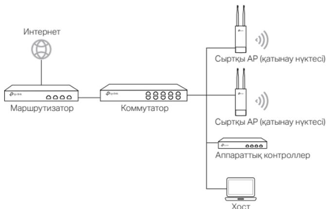
Аппараттық контроллер Арс-мен бірдей немесе басқа ішкі желіде болуы мүмкін. Басқару торабы аппараттық контроллерге кіріп, Арс-ді орталықтандырылып басқару үшін қолданылады.
