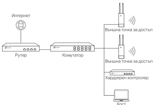
Хардуерният контролер може да бъде в същата или различна подмрежа с точките за достъп (AP). Хостът за управление се използва за влизане в хардуерния контролер, за да управлява централно точките за достъп.
