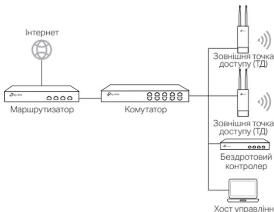
Апаратний контролер може знаходитись в одній чи різних з ТД підмережах. Хост управління використовується, щоб увійти на апаратний контролер для централізованого керування ТД.
