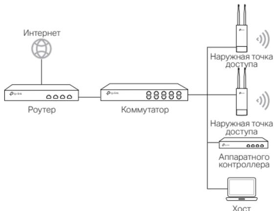
Аппаратный контроллер может находиться в одной или разных подсетях с точками доступа. Хост управления применяется для входа в аппаратный контроллер для централизованного управления точками доступа.
