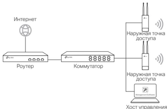
Компьютер, на котором используется централизованное ПО управления и который может находиться в одной или разных подсетях с точками доступа, применяется для централизованного управления точками доступа.
