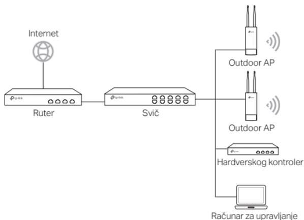
Hardverskog kontroler može biti u istom ili različitom domenu od AP-a. Računar za upravljanje se koristi za pristup hardverskog kontroleru da bi bežično upravljao AP-ovima.
