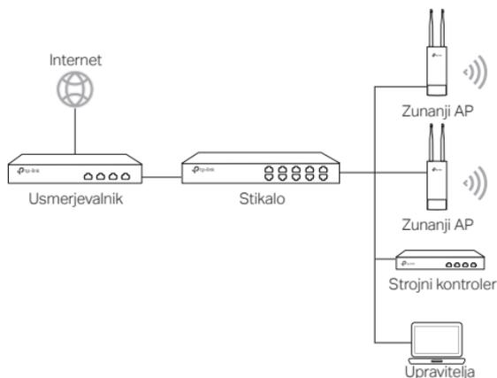
Strojni kontroler je lahko priključen na enako ali drugo podomrežje (subnet). Management host se uporablja za namenom dostopa na strojni kontroler za centralno upravljanje dostopnih točk.
