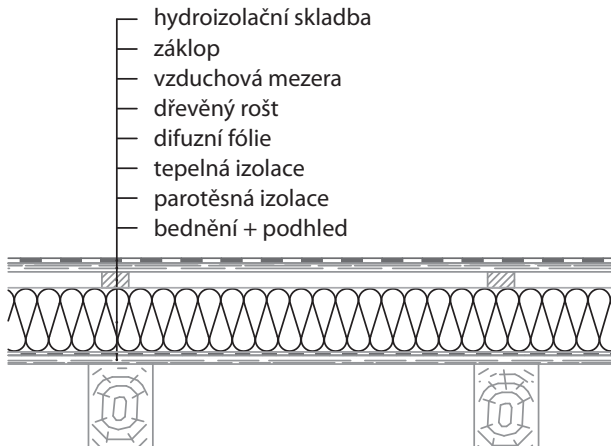
Obr. č. 7 - Dvouplášťová střecha s viditelnými trámy.
