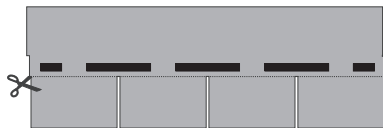
Obr. 2 - Úprava zakládacích šablon
